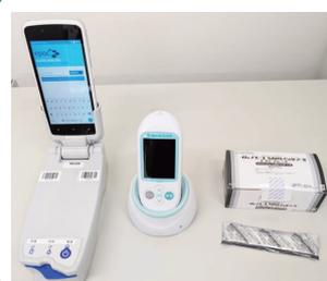
左：血液ガス分析装置 (NXS ホスト搭載エポック) 13項目を1分以内に測定できる。
